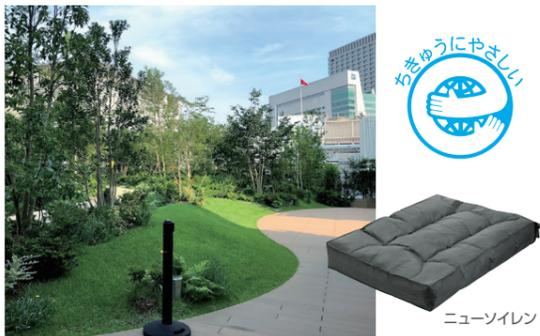
使用済み発泡ポリスチレンの粉碎粒を100%使用した「ニューソイレン」(軽量排水材)を用いた緑化工法です。軽量の人工土壌により建物への荷重負荷を軽減し、都市部の景観づくりおよびヒートアイランド対策に貢献します。「ニューソイレン」はエコマーク認定商品です。
