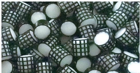
保水力に優れ、汚水を浄化する微生物を高濃度に保持させやすい特徴を持つ、DHS水浄化システム用のスポンジ(連続気泡ポリウレタン発泡)担体です。工場排水やコミュニティの生活排水などを低コストで効率よく浄化することができ、河川などの水域における環境負荷低減に貢献します。
