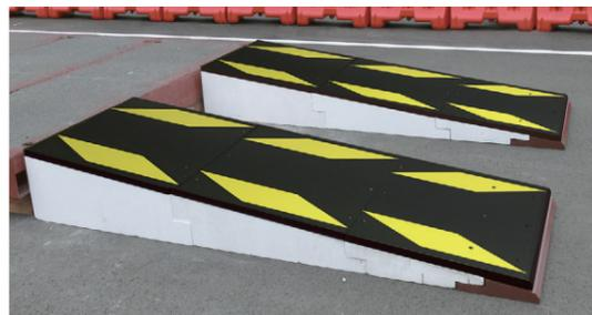
首都高速道路株式会社様と共同開発した、地震時損傷個所に対する速やかな応急復旧を可能とする軽量段差解消材です。軽量なので重機を使用する必要がなく、設置時の省エネルギーに優れ、かつ分割して保管・輸送ができるという新たな価値を実現しました。従来の[土のう+敷鉄板]による段差解消に比べ、30cm段差解消1セットあたりのCO<sub>2</sub>発生量を約79%(約1,390 kg-CO<sub>2</sub>)削減できます。
