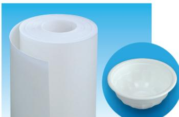
成形メーカーと連携した独自リサイクルシステムで得られた再生原料を、発泡層に15% (製品全体の10%) 以上使用し、バージン原料100%の非発泡層をラミネートした多層構造の発泡ポリスチレンシートです。食品接触面は非発泡層で、食品容器用途の適合性も確保しています。
