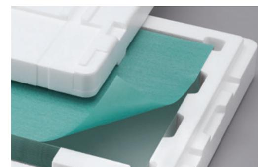
帯電防止機能に持続性があり、繰り返しの使用にも耐える非架橋の高発泡ポリプロピレン系シートで、デジタル家電や電子部品向け表面保護材などに使用できます。独自の発泡技術を発展させ、製品の要求品質を保持したまま、さらに高倍発泡化することで、従来品に比べ30%以上の重量軽量化を図りました。
