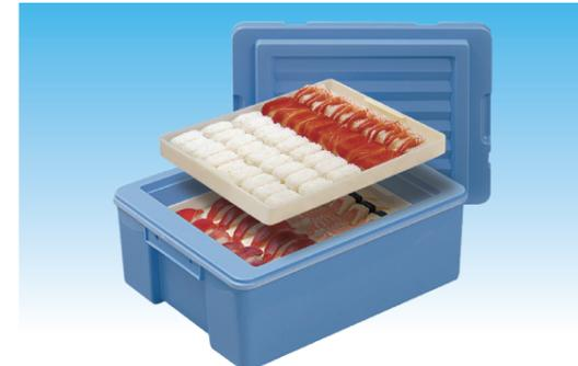
保温、保冷性に優れた発泡ポリウレタンをコア材に、内外装に非発泡のポリプロピレンを使用した断熱コンテナです。耐衝撃性が高く、衛生的で耐久性に優れており、接着剤を使用していないため、食品配送用や食品の一時保管用容器として、安心して繰り返し使用(Reuse)することができます。
