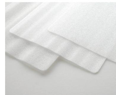
植物由来のポリエチレンを使用し、バイオマス度10%以上とした無架橋高発泡ポリエチレンシートです。従来品同様、軟質でクッション性に富み、断熱性、防水・防湿性や耐薬品性に優れた素材として、各種包装資材や、農業資材、雑貨など、さまざまな用途に使用できます。
