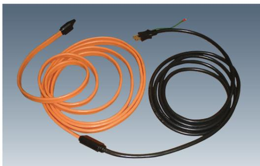
PTC セラミックスを発熱体とした自己出力制御・並列回路型のテープ状ヒーターです。環境温度変化に応じて出力を自己制御するため無駄な電力の消費がなく、オーバーヒートの心配がないため、安全に融雪や凍結防止、温度管理等の用途で幅広く使用することができます。一般の電熱線ヒーターとサーモスタットの組み合わせと比較して、製品使用時のCO<sub>2</sub>排出量を約30%削減することができます。
